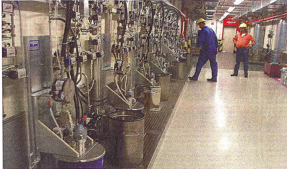
Die Farbversorgung für die Lackieranlage sorgt für die richtige Mischung der Farben.
